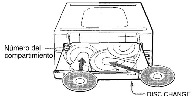
Para cargar de tres a cinco discos, pulse **DISC CHANGE** para que gire la bandeja después de haber colocado dos discos. Coloque el disco siguiente en un compartimiento vacío. Cada vez que pulse **DISC CHANGE**, la bandeja girará y podrá colocar un disco.
